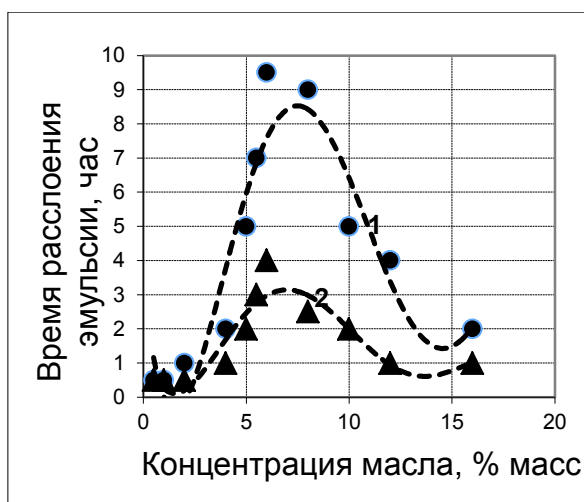
Рис. 6. Зависимость времени расслоения модельных эмульсий от концентрации масла: 1 - АПАВ; 2 – НПАВ. [\text{ПАВ}] = 6 \text{ моль/м}^3
