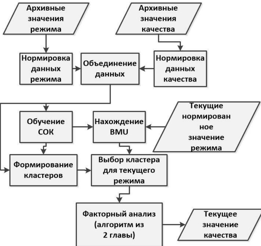
Рисунок 6. Блок схема алгоритма построения модели на основе карты Кохонена
