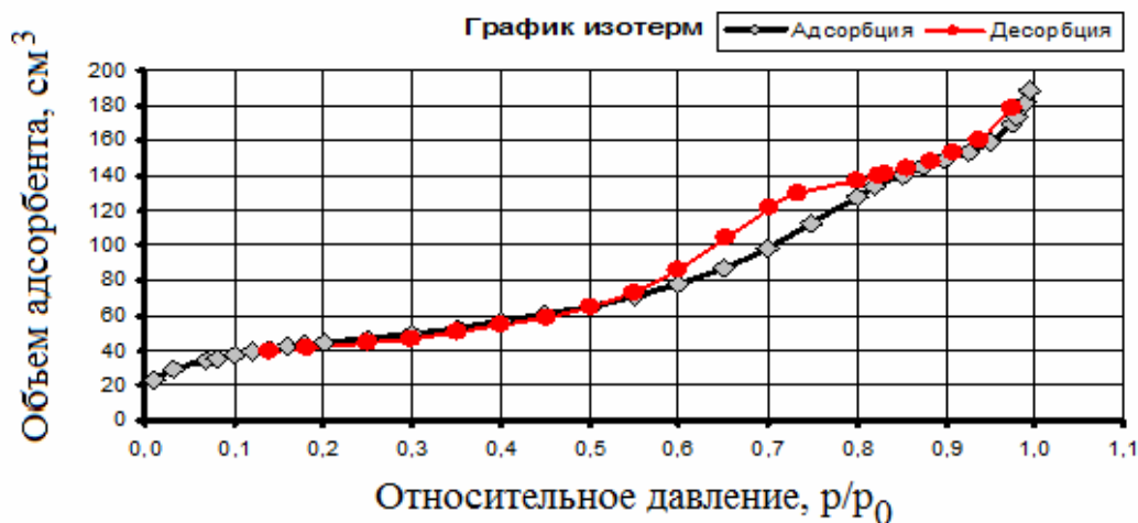
Рис.7. Кривые сорбции – десорбции для порошка УФ – 44, полученные методом низкотемпературной адсорбции жидкого азота, p_0 – давление насыщенного азота
