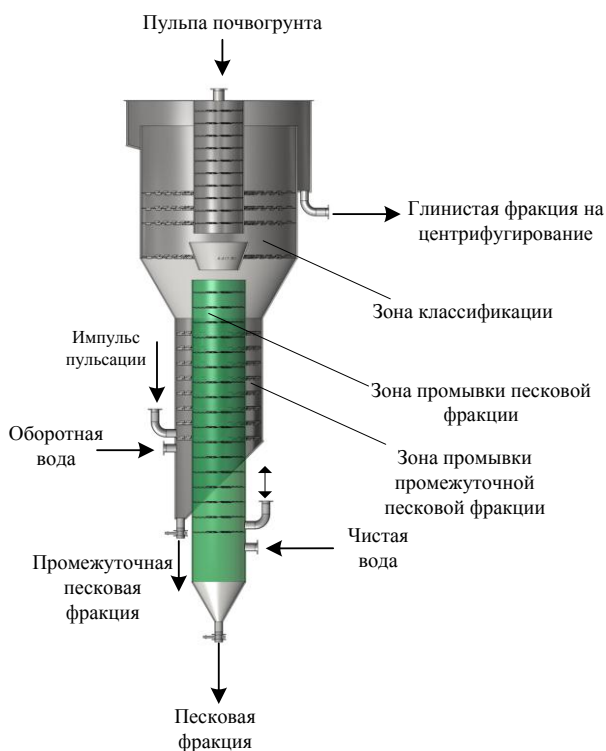
Рис. 1 Пульсационная колонна
