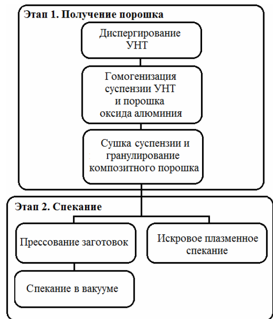
Рис. 2. Стадии получения композита Al 2 O 3 -УНТ.
