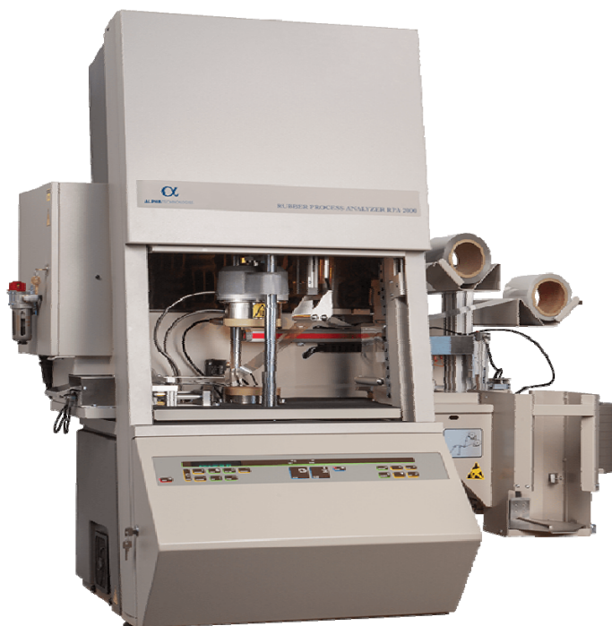
Рис. 10. Прибор Анализатор перерабатываемости резин RPA-2000 фирмы Alpha Technologies.
