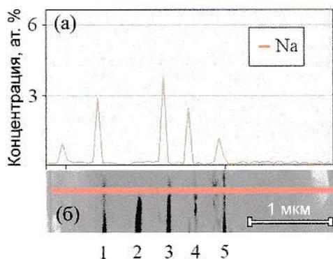
Рисунок 3 – ПЭМ-изображение поперечного среза нанорешетки, сформированной под действием  $10^7$  лазерных импульсов (а) и соответствующий профиль концентрации ионов Na, зарегистрированный вдоль оранжевой линии (б).
