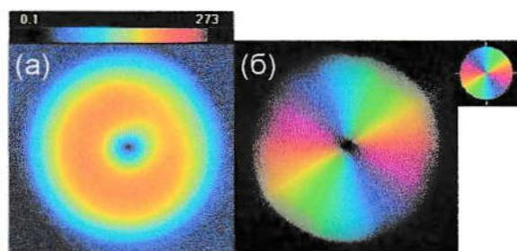
Рисунок 8 – Псевдоцветовые карты измеренных параметров двулучепреломления конвертера поляризации диаметром 100 мкм, записанного в объеме стекла AF32: (а) фазовый сдвиг, нм и (б) ориентация медленной оси.
