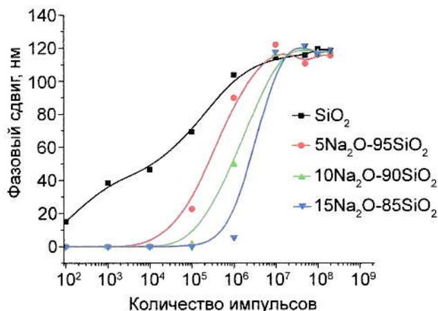
Рисунок 5 – Зависимости фазового сдвига от количества сформированных нанорешетку лазерных импульсов для стекол с различным содержанием  $\text{R}_2\text{O}$ .
