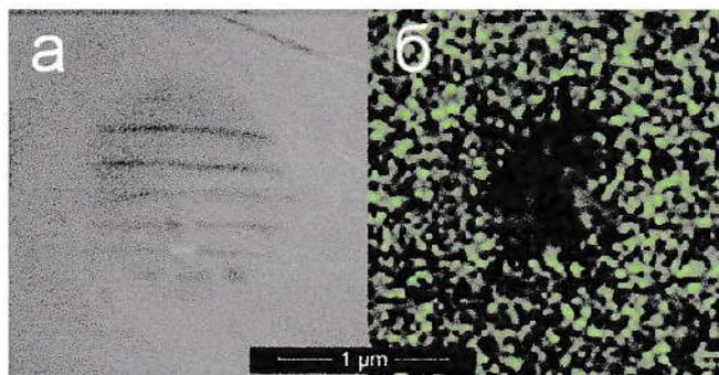
Рисунок 2 – СЭМ-изображение нанорешетки, сформированной в объеме стекла состава  $15\text{Na}_2\text{O}\cdot 85\text{SiO}_2$  (а); карта распределения катионов  $\text{Na}^+$ , демонстрирующая снижение их содержания в нанорешетке (б).
