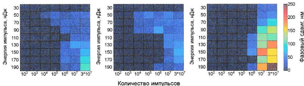
Рисунок 6 – Псевдоцветные карты зависимости фазового сдвига от энергии и количества импульсов для стекол  $23\text{Li}_2\text{O}\cdot 77\text{SiO}_2$  (а),  $23\text{Na}_2\text{O}\cdot 77\text{SiO}_2$  (б),  $23\text{K}_2\text{O}\cdot 77\text{SiO}_2$  (в) (частота следования 200 кГц, длительность импульса 600 фс).
