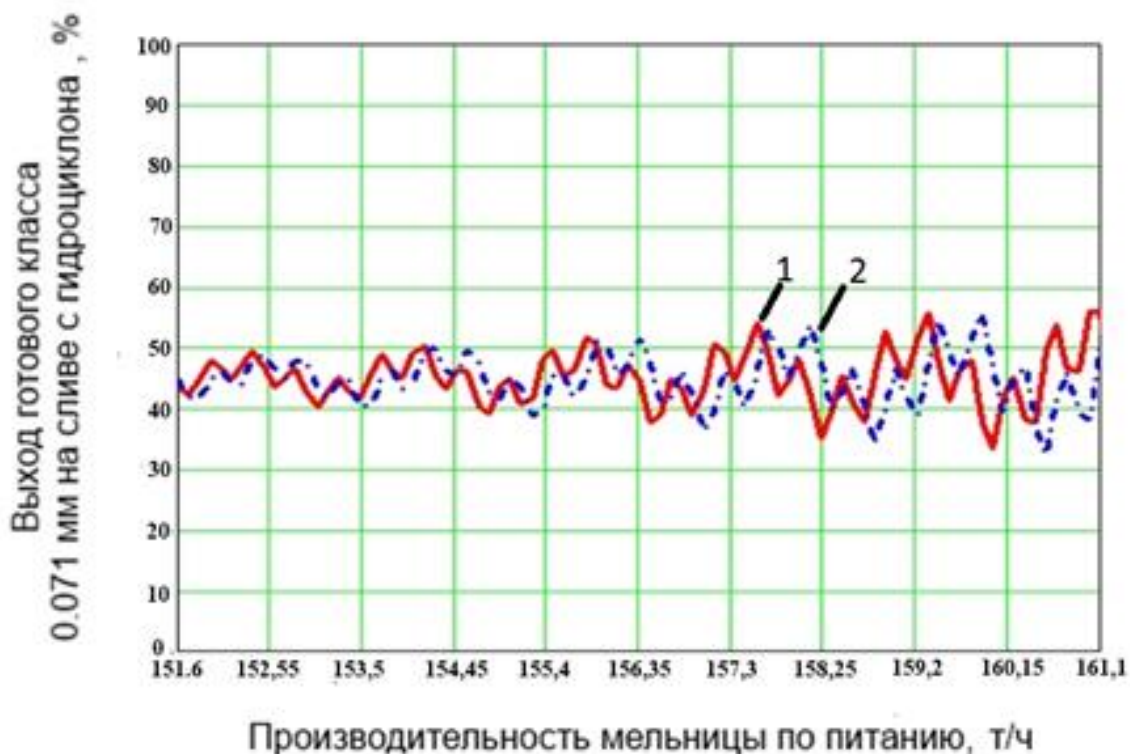
Рисунок 5 – Изменение содержания готового класса крупности 0,071 мм (1-экспериментальные данные, 2-результаты расчета по модели)
