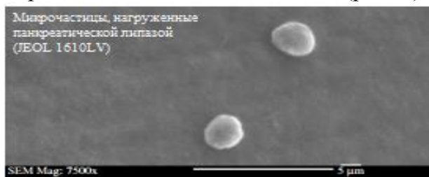
Рисунок 1 – Определение размера микрочастиц, нагруженных панкреатической липазой (сканирующий электронный микроскоп JEOL 1610LV с энергодисперсионным спектрометром для электронно-зондового микроанализа SSD X-Max Inca Energy)
