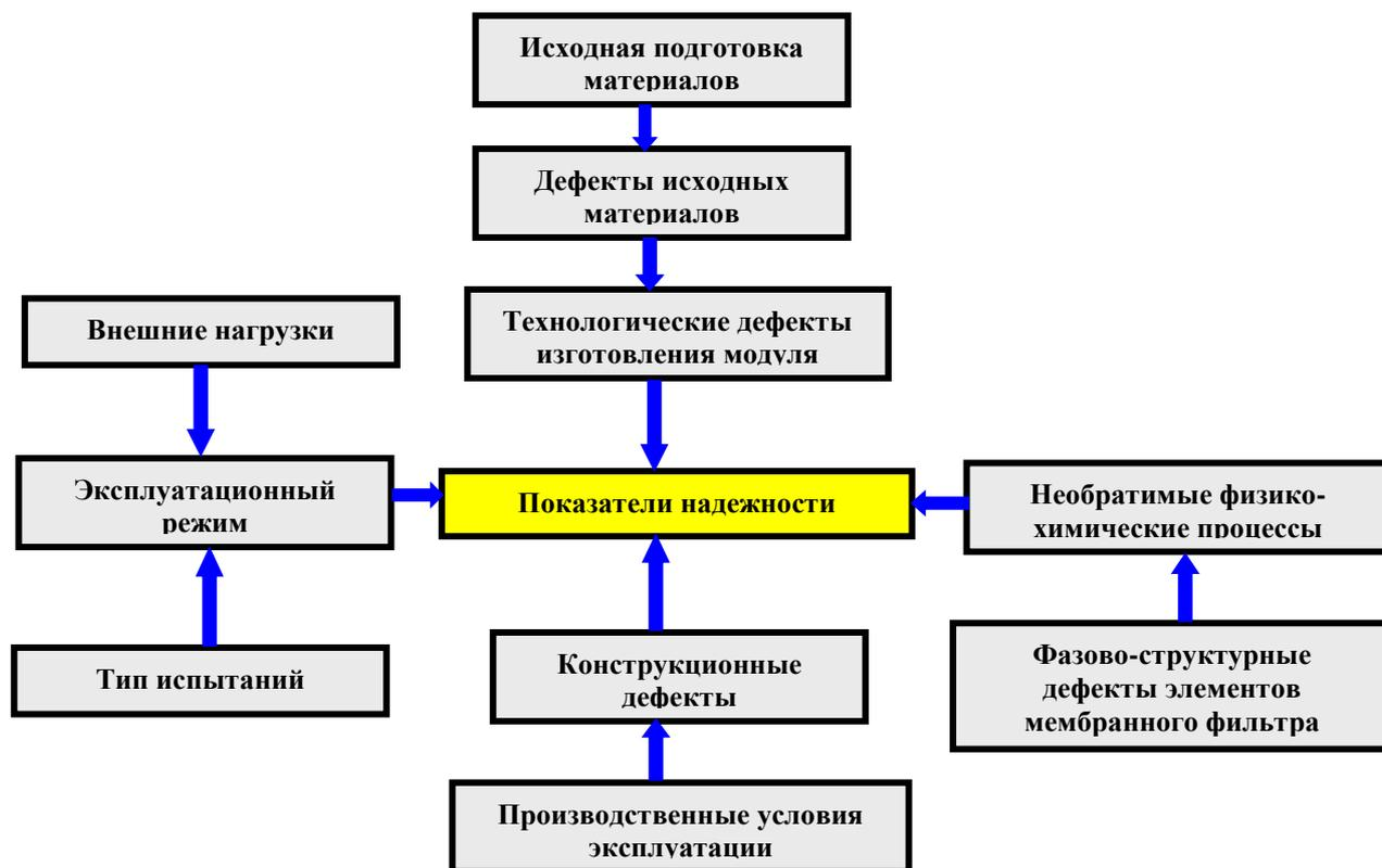
Рис.12. Структурная схема взаимосвязи основных факторов, влияющих на надежность работы мембранных фильтров
