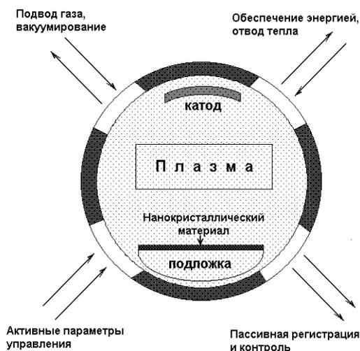
Рис. 1. Схема технологии формирования наноструктурных мембран
