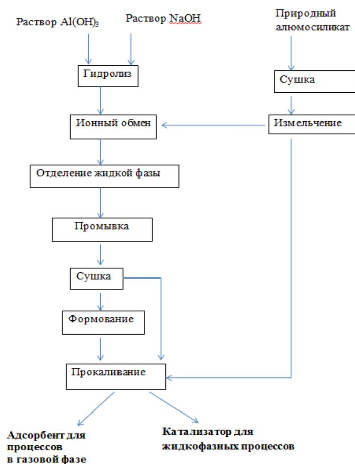
**Рис. 7.** Принципиальная технологическая схема получения адсорбентов и катализаторов из природных слоистых алюмосиликатов
