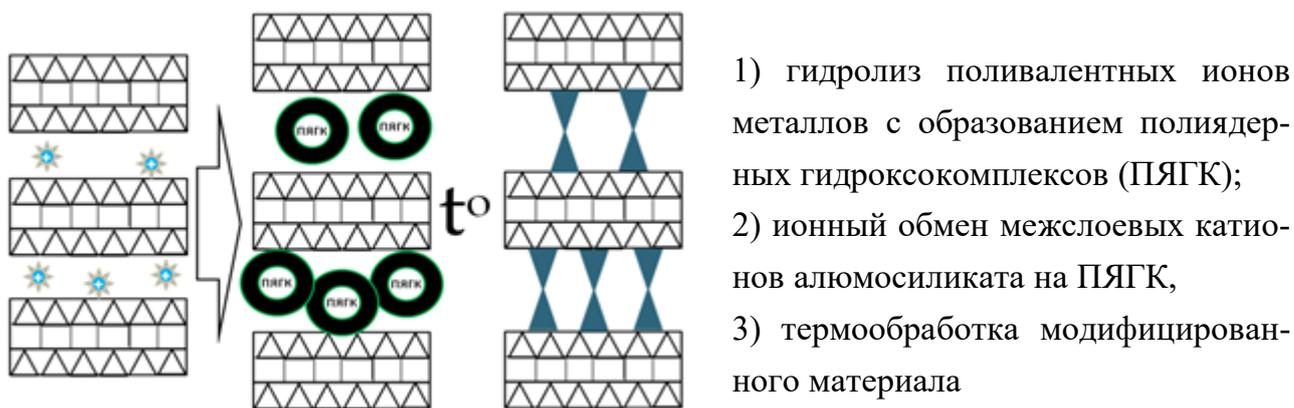
**Рис. 1.** Схема пилларирования слоистых алюмосиликатов
