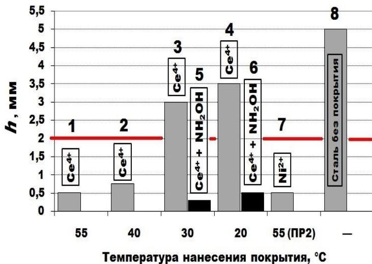
Рис.11. Результаты коррозионных испытаний по стандарту ИСО 9223.
