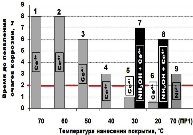
Рис. 10. Результаты коррозионных испытаний по стандарту ИСО 9227.
