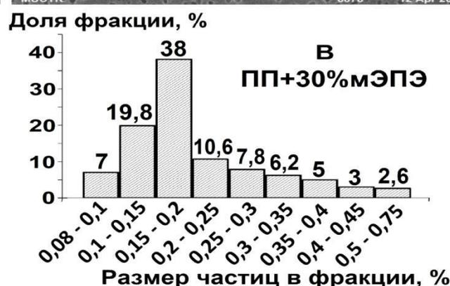
Рис. 2. СЭМ микрофотографии обработанных поверхностей сколов образцов ПП/мЭПЭ и соответствующие гистограммы распределения частиц эластомерной фазы по размерам
