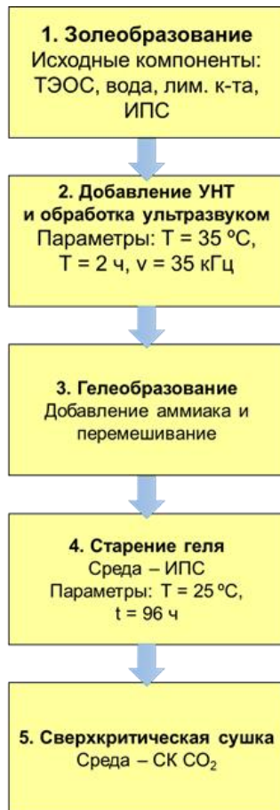
Рисунок 5 – Схема получения монолитов кремниевых аэрогелей с УНТ золь-гель методом
