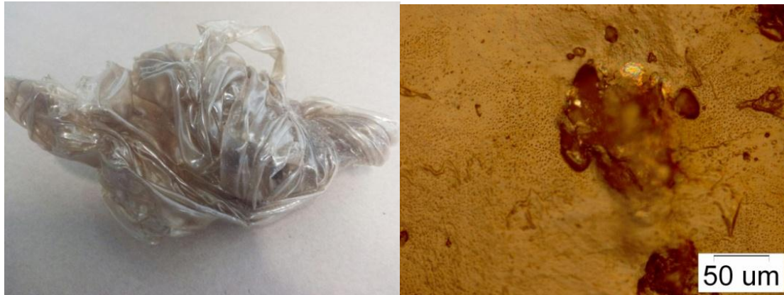
Рисунок 2 – Фотографии образца пленки, изготовленной на основе ПВХ и пектина при температуре 170 °С
