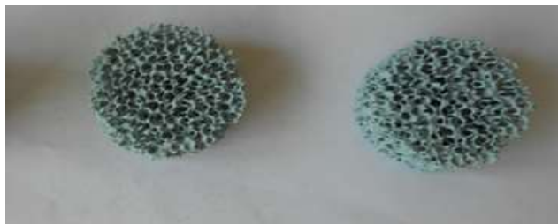
Рис.12. Внешний вид полученных ВПЯМ после обжига
