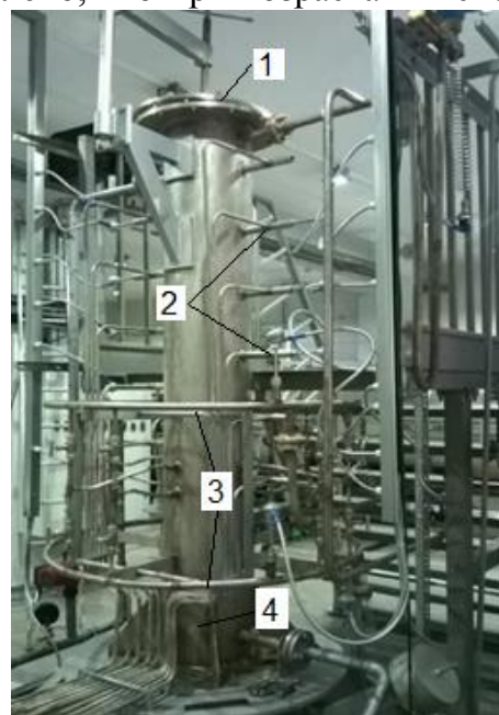
Рис. 4. Общий вид опытной установки исследования процессов слоевого горения углей (1 – патрубок подачи угля; 2 – патрубки выхода газофазных продуктов горения; 3 – патрубки подвода окислительной среды; 4 - бункер накопления золы).
