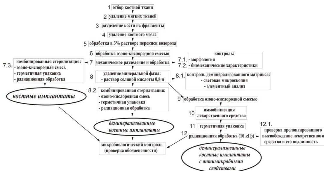
Рисунок 4 - Схема-алгоритм технологии получения костных имплантатов и имплантационных препаратов
