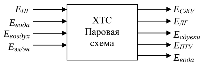
Рис. 2. Эксергетические потоки ХТС получения СЖУ на базе паровой конверсии метана: E_{\text{ПГ}} – эксергия ПГ; E_{\text{эл/эн}} – необходимая мощность электроприводов машин; E_{\text{вода}} и
