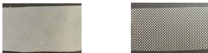
Рис. 1. Ситовая сетка. Плетение без узелков под углом 45^0 . Монофиламентное волокно – 0,1 мм для канала крови (слева), и 0,2 мм для канала плазмы (справа)
