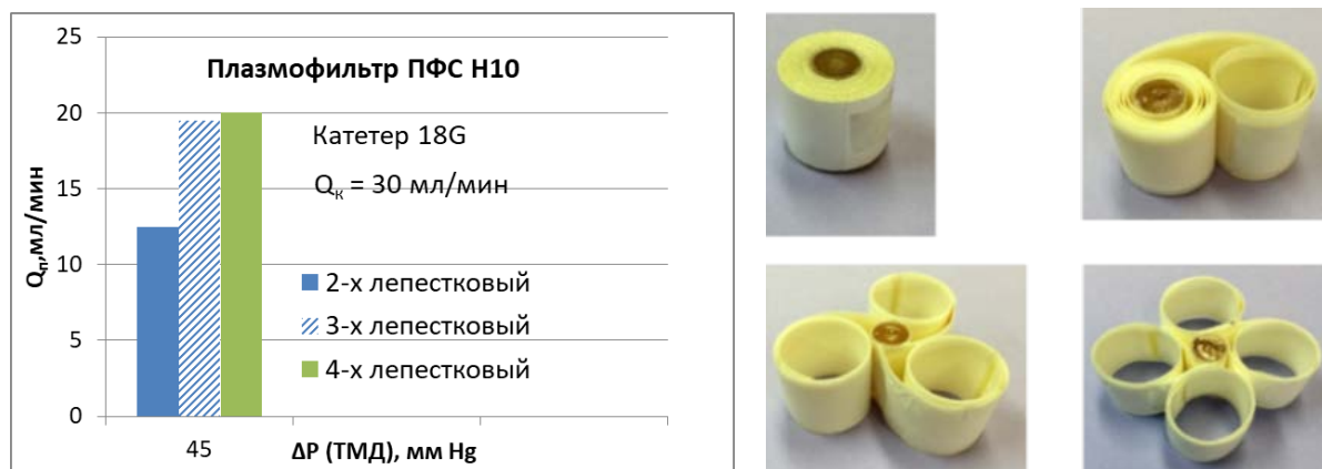
Рис.6. Фильтрация плазмы плазмофилтром с 2-х, 3-х и 4-х лепестковым модулем.
