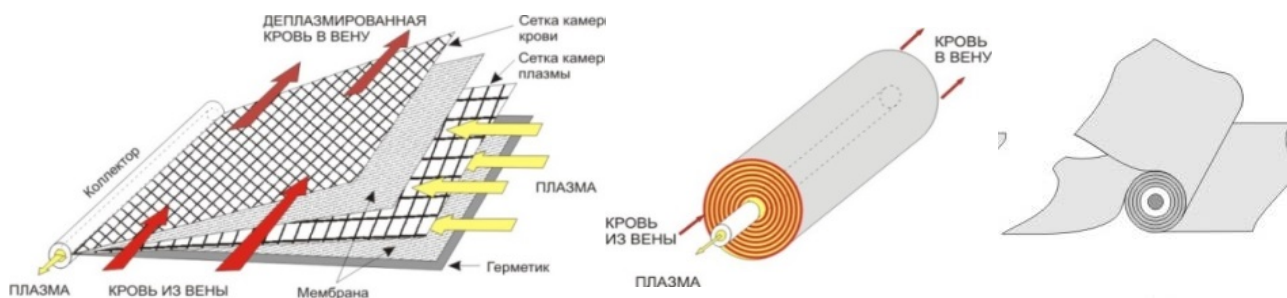
Рис. 2. Схема в развернутом и свернутом виде 1-го лепестка мембранного модуля и его 3-х лепестковый вариант (справа). Лепесток (пакет) – целостный элемент из 2-х мембран, проложенных сеткой, герметичный по 3 - м сторонам.
