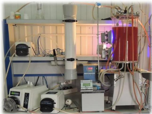
Рис. 2. Комплекс для высокоплотного культивирования галобактерий.
