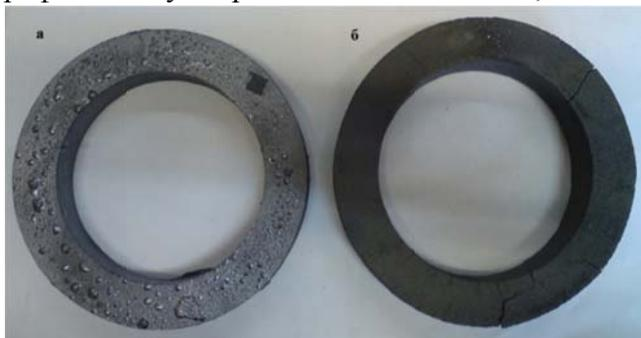
Рис. 9. Внешний вид колец из силицированного графита, полученных в одном процессе силицирования (а – бездефектное кольцо, б – кольцо серого цвета с дефектами в виде формоизменения, трещин, выпарившегося кремния)
