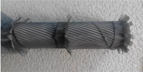
Рис. 8. Фрагмент блока рулонной ленточно-винтовой насадки
