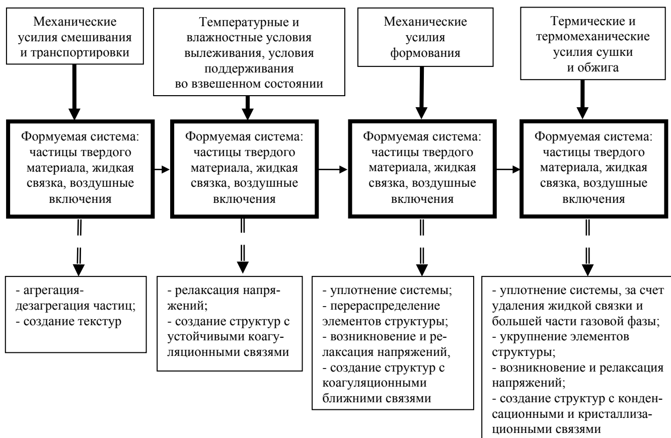
Рисунок 10 – Схема энергетических воздействий на материал и полуфабрикат на разных стадиях производства изделий
