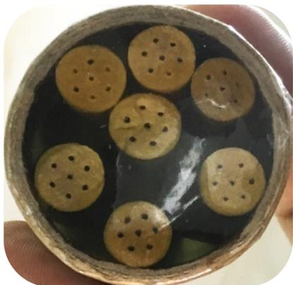
**Рисунок 1. Фотография торца заряда ПВГС на основе ПП марки 14/7**
