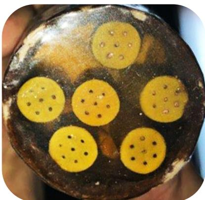
**Рисунок 3. Фотография торца заряда ПВГС на основе ПП марки 14/7 с заполненными каналами пороховых элементов**
