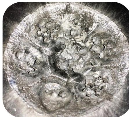
**Рисунок 2. Фотография пластины-свидетеля после взрыва ПВГС**
