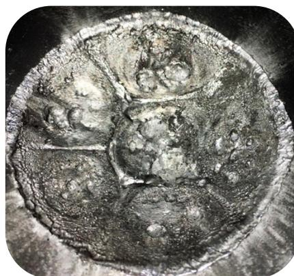
**Рисунок 4. Фотография пластины-свидетеля после взрыва ПВГС с заполненными каналами пороховых элементов**
