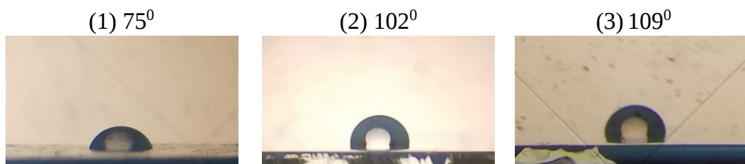
Рис.20. Значения краевого угла смачивания водой покрытий на основе ЭД-20: 1- покрытие Е; 2- покрытие EU-Si; 3- покрытие EZnO
