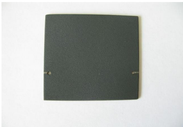
Рис. 7. Внешний вид покрытия на основе синтезированного хромита никеля (плазменное напыление)
