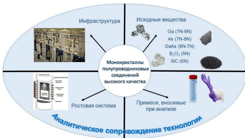
Рис. 8. Схема комплексного подхода к оценке химической чистоты технологических процессов получения высокочистых веществ
