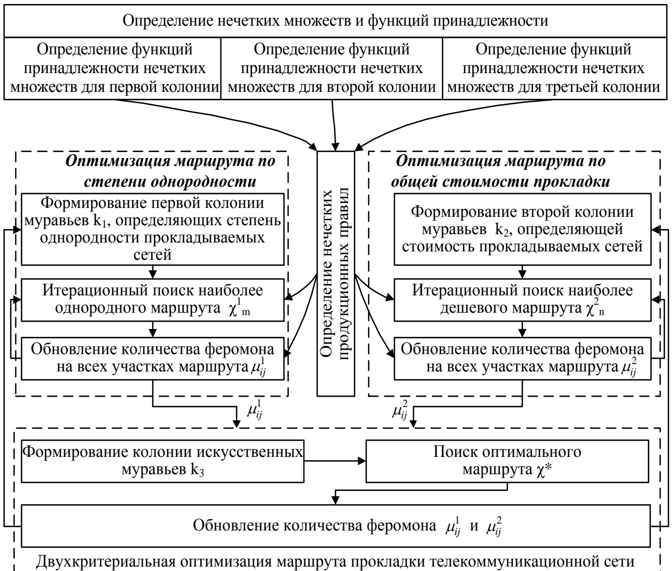
Рисунок 1 – Обобщенная блок-схема иерархического многоколонияльного муравьиного алгоритма оптимизации по минимуму затрат и унифицированности структуры ТЛКС НТП
