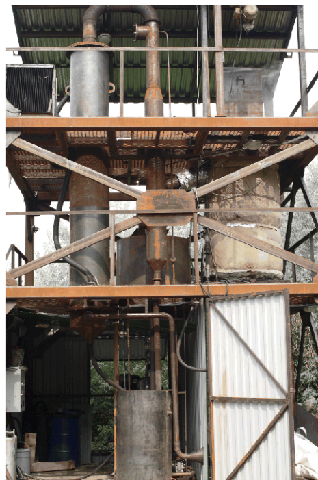
Рисунок 36 – Установка пиролиза органического сырья
