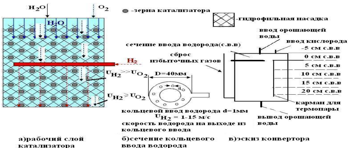
Рис (3). Схема конвертора низкотемпературного окисления водорода
