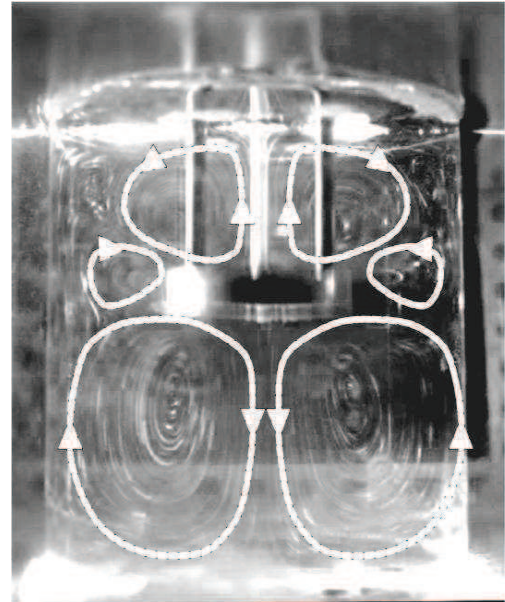
I_a=0,35 \text{ м/с}^2 устойчивое симметрич- ное ламинарное восходящее течение к кристаллу ( вынужденное течение )
