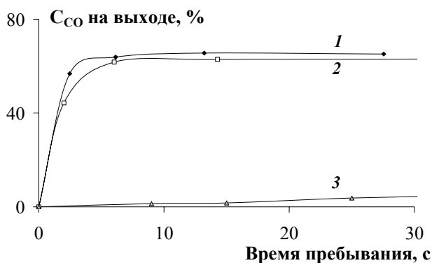
Рис. 6. Влияние добавок при нанесении на БАУ-А, t=700^{\circ}\text{C} : 1 – 5 % Со; 2 – 5 % Ni; 3 – без добавок
