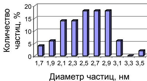
Рисунок 5 – ПЭМ - фотографии образцов и гистограммы распределения размеров Ru-содержащих частиц: а) отработанного катализатора Ru/CPS MN 270 ( H_2 ), б) Ru/CPS MN 270 ( N_2H_4 ) и в) Ru/CPS MN 270 ( NaBH_4 )
