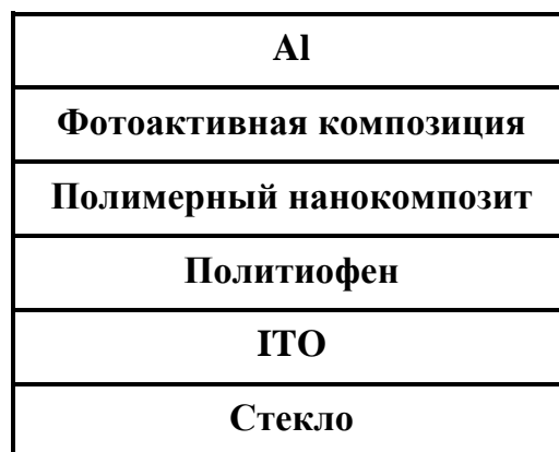
Рис. 11. Схема фотовольтаического элемента
