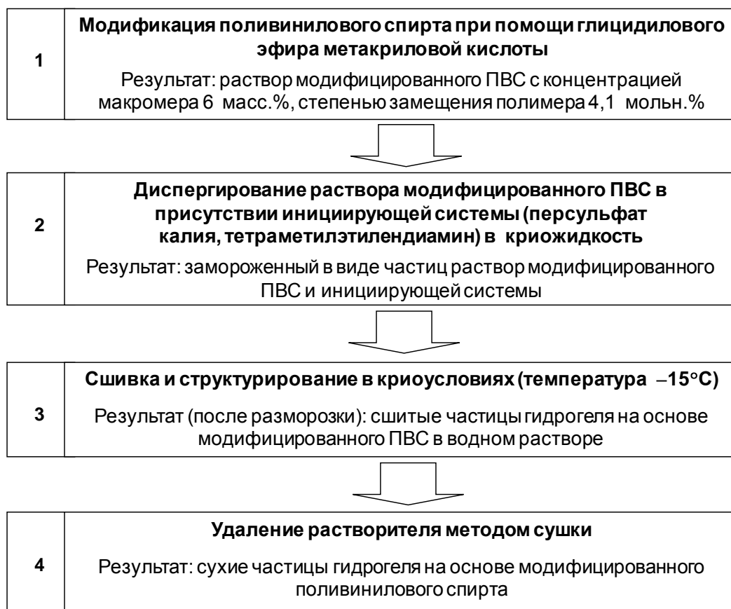
Рис. 1. Основные этапы процесса получения макропористых частиц гидрогелей на основе ПВС
