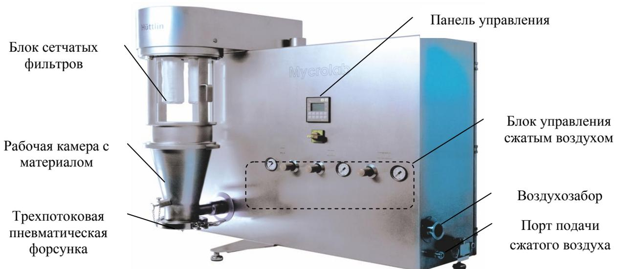
*Рис. 3. Лабораторная установка Hüttlin Mycrolab, OYSTAR GmbH*
