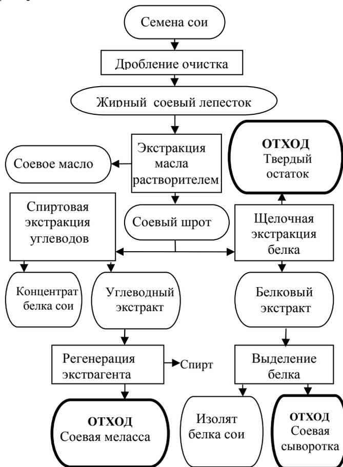
Схема. 1. Схема переработки соевых бобов с получением концентрированных белковых продуктов
