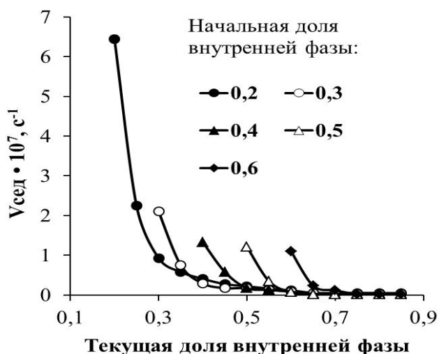
Рис. 9. Экспериментальные зависимости скорости седиментации в обратных эмульсиях от доли дисперсной фазы
