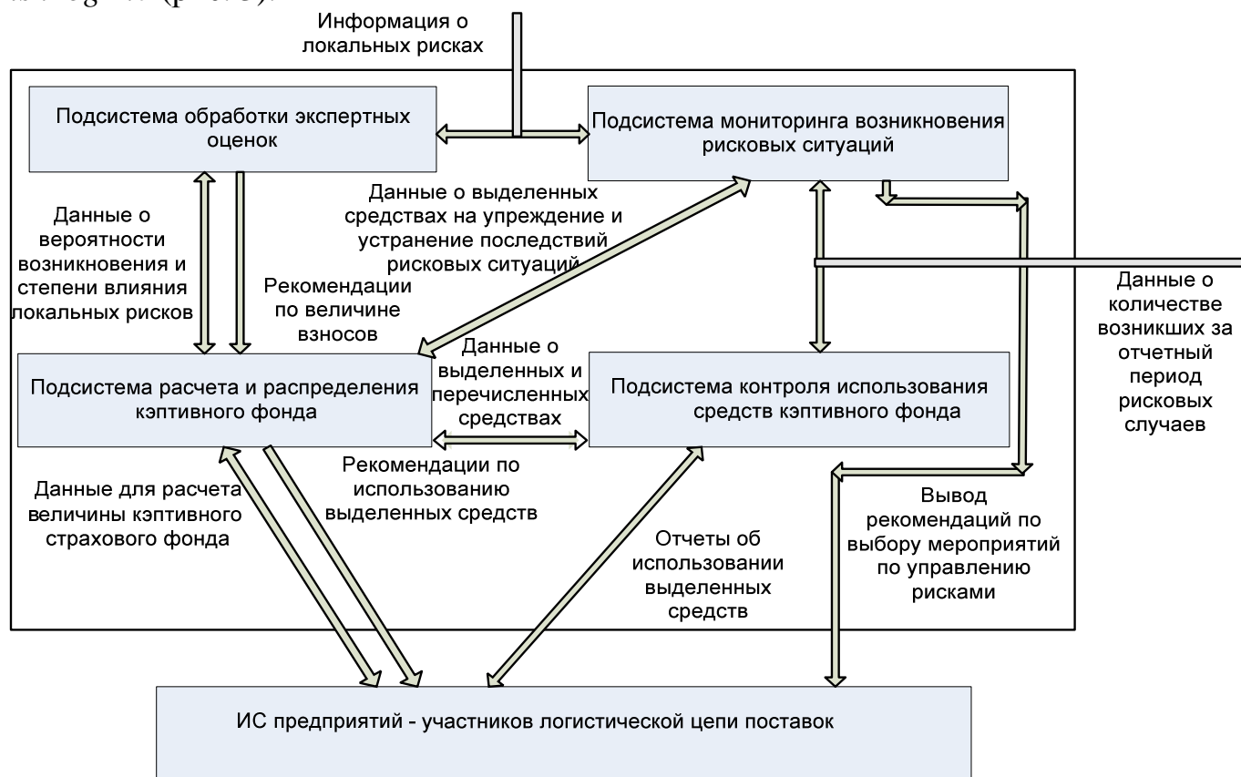
Рис. 3 – Блок-схема архитектуры информационной системы управления рисками в ЦП предприятий шинной промышленности RiskLog 1.0
