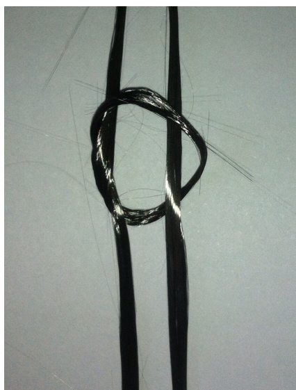
Рис. 6. Изображение незатянутой петли из углеродного волокна.
