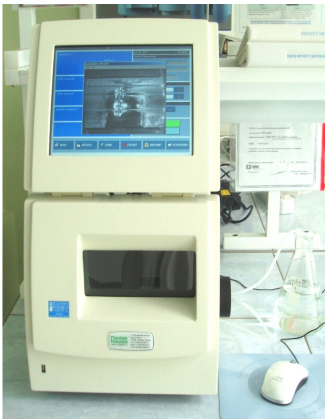
Рисунок 2.4. Внешний вид цифрового денситометра DDM 2910.
