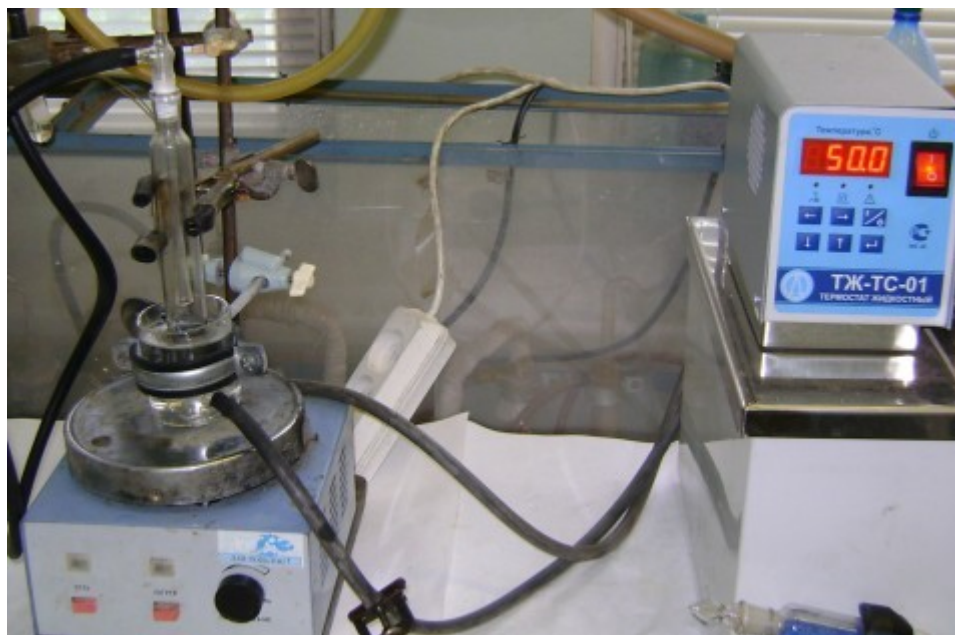
Рисунок 2.9. Фрагмент внешнего вида установки для приготовления комплексных соединений вида NX \cdot D и изучения фазового равновесия в двухфазных системах.
