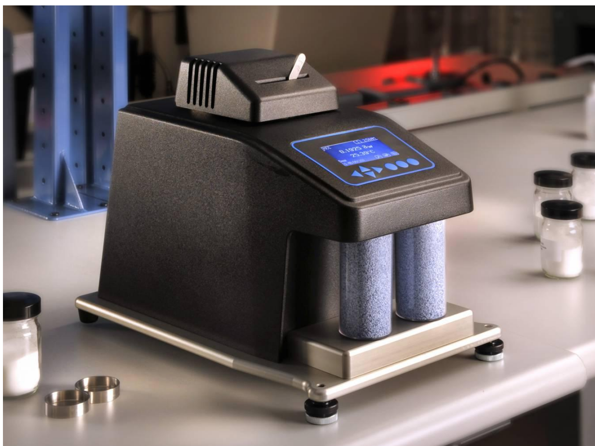
Рисунок 2.26 Генератор изотерм сорбции Vapor Sorption Analyzer фирмы Decagon Devices
