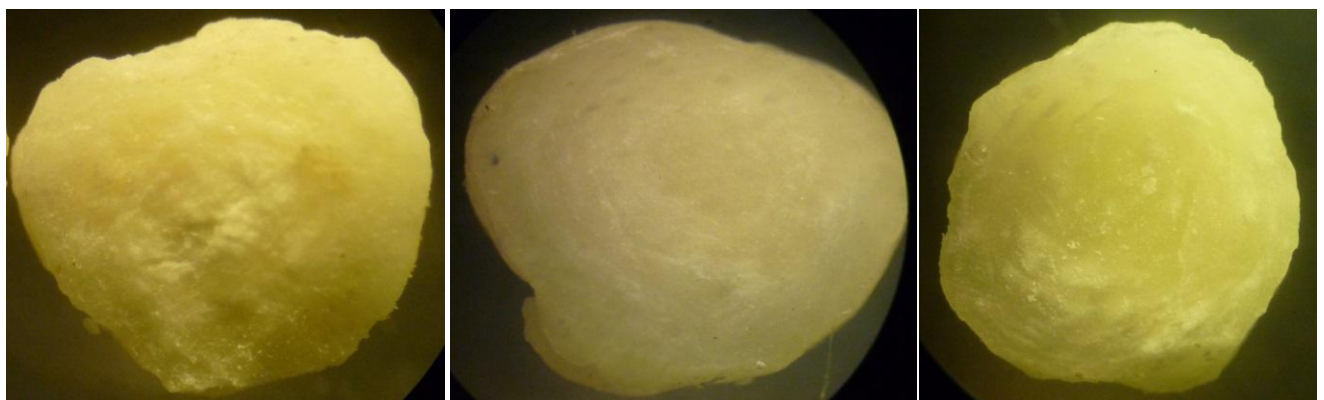
Рис. 2.23 Электронные фотографии среза гранул ДАФ с различным содержанием MgO (увеличение \times 25 )
