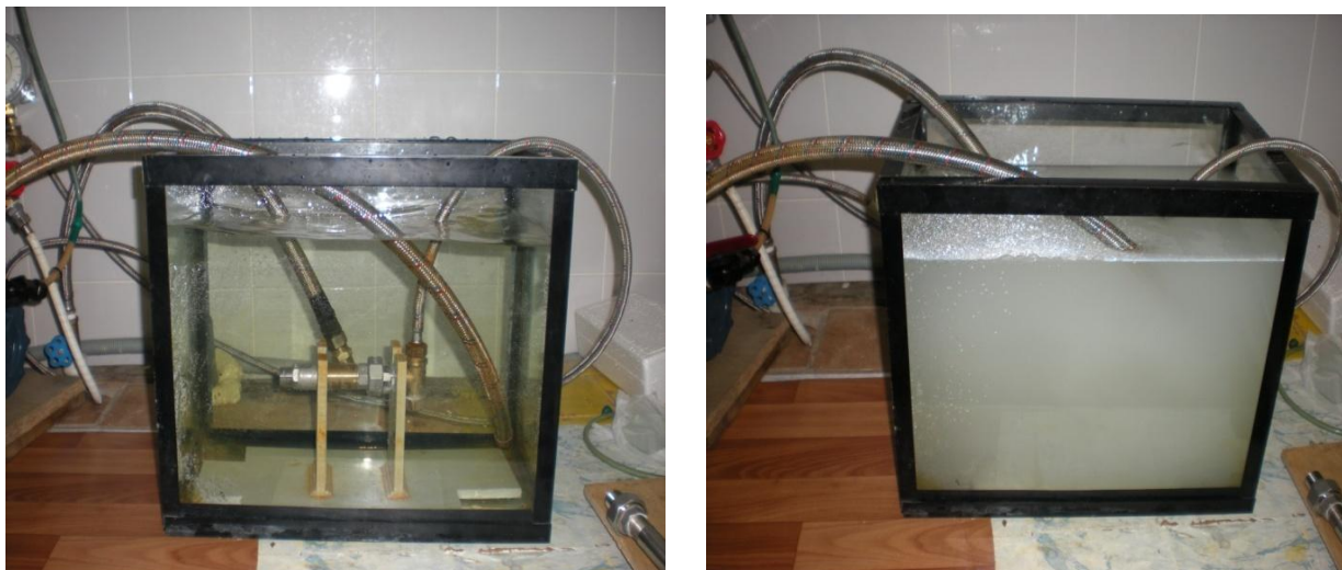
Рис. 7 – Фотографии ячейки с водой до и после волновой обработки
