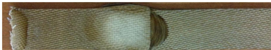
Рисунок 4.3 – Общий вид сварных образцов, изготовленных сваркой нагретым инструментом косвенным нагревом без применения дистанционного элемента (фото образцов - вид сверху)
