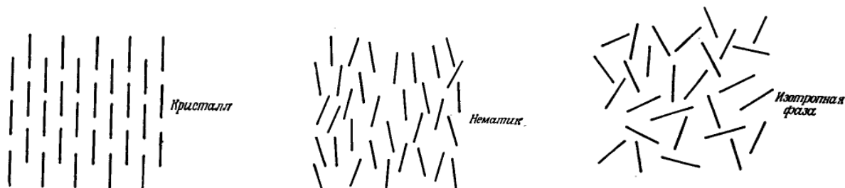
Рис. 1.1. Схема молекулярного порядка в кристаллической, нематической и изотропной фазах жидкого кристалла [81]
