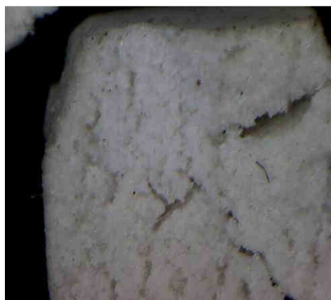
Образец катализатор на основе полипропилена (увеличение x200)
