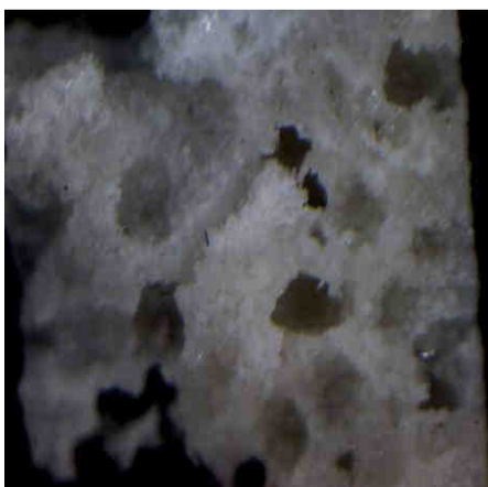
Образец катализатор на основе полистирола (увеличение x200)
