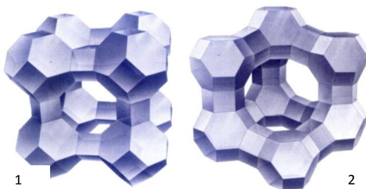
Рис. 1.9. Внешний вид решетки цеолитов: 1- молекулярное сито типа А, молекулярное сито типа Х.
