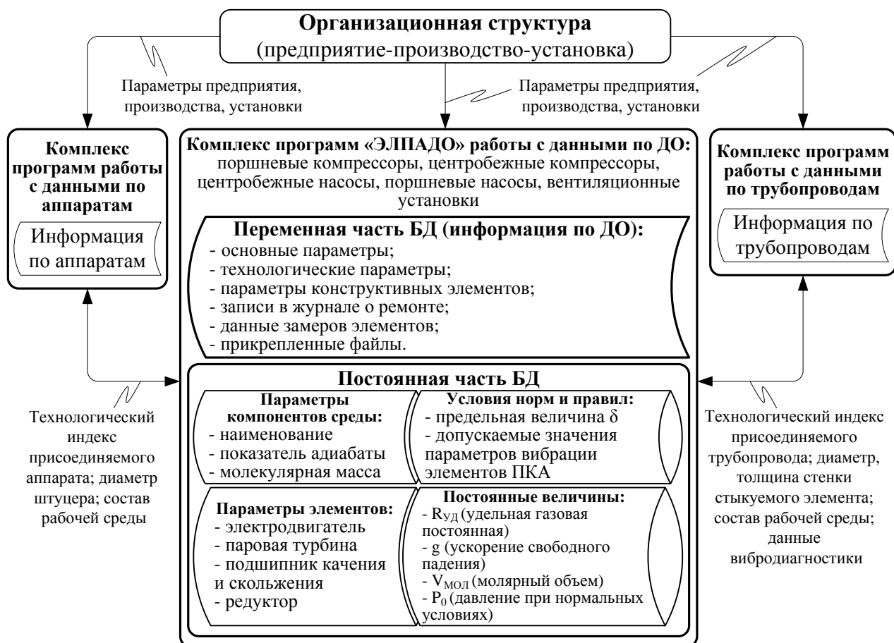
Рисунок 4.2.1.1 – Структура блока «База данных» и его взаимодействие с комплексами программ по аппаратам, трубопроводам
