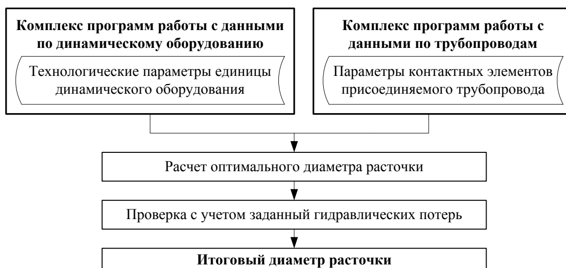
Рисунок 4.3.2.1 –Блок-схема работы блока «Диафрагма»
