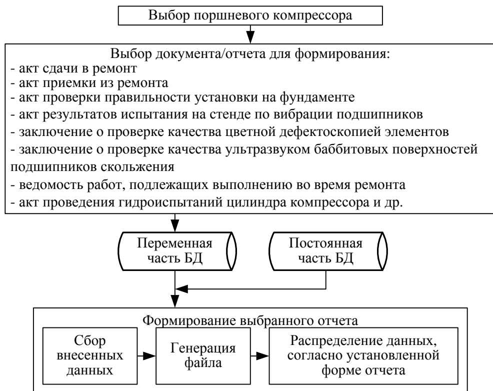
Рисунок 4.3.1.2 – Блок-схема работы блока «Отчеты»
