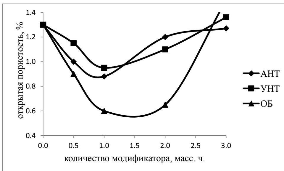
Рис. 23 . Зависимость открытой пористости связующих на основе ЭД-20 от количества и природы наномодификатора
