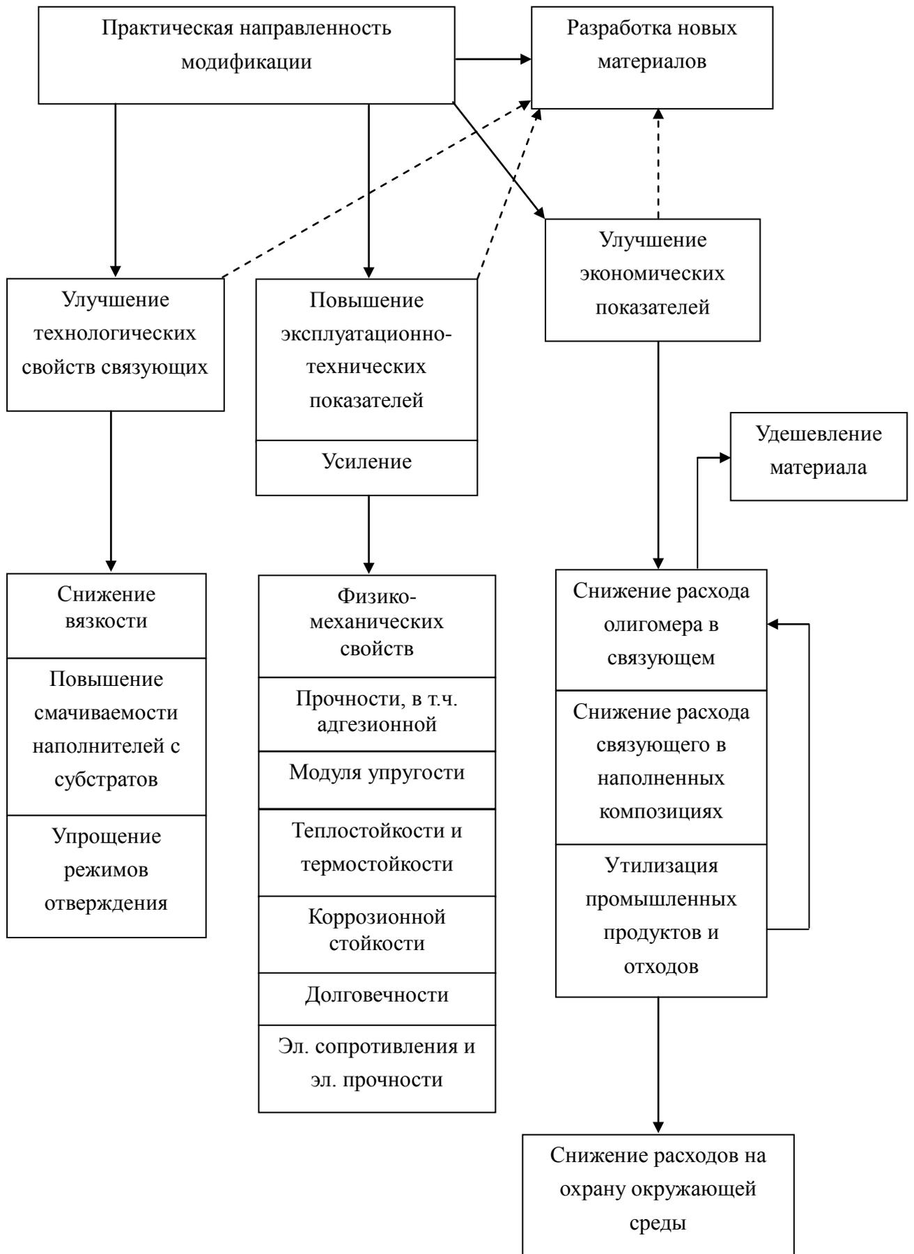
Рис. 2. Задачи модификации эпоксидных полимеров
